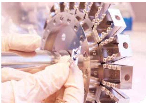
► An der TU Bergakademie Freiberg wurden die Zirkonkristalle aus der am Bromacker gesammelten Gesteinsprobe radiometrisch analysiert. Hier: Ein Probenrevolver und ein Glühdraht des Massenspektrometers.
