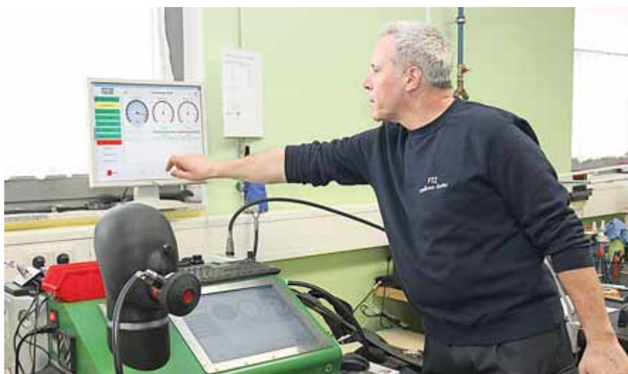
| Norbert Reißer, Mitarbeiter des Feuerwehrtechnischen Zentrums, präsentiert das neue Prüfgerät für Atemschutztechnik.
