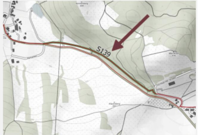
IST-Zustand: Es existiert kein straßenbegleitender Geh- und Radweg. Der Radverkehr wird auf der Fahrbahn geführt. Die zulässige Höchstgeschwindigkeit liegt bei 100 km/h. Es gibt derzeit keine geeignete Alternativverbindung.
