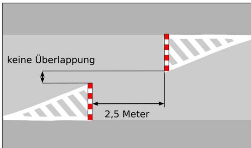
Abbildung 2: Empfohlene Anordnung von Umlaufsperrn - Einsatz von Umlaufsperrn nur bei besonderer Gefahrenlage
