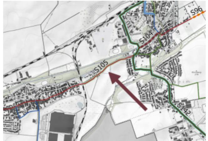
IST-Zustand: Der vorhandene (Zweirichtungs-) Geh- und Radweg ist zu schmal. Einrichtung eines gesicherten baulichen Übergangs Fahrbahn-Radweg am Beginn und Ende des Radwegs.
