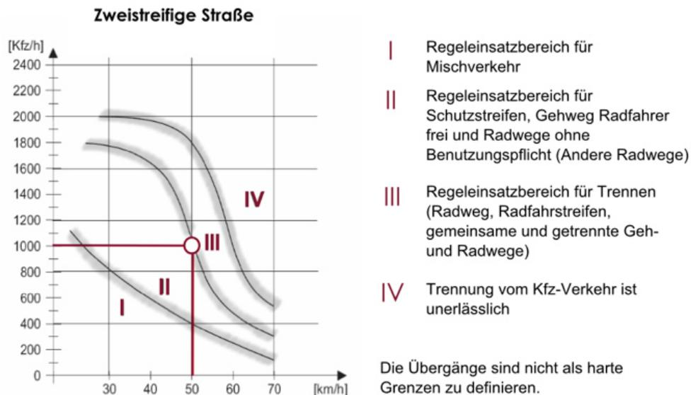
**Abbildung 5:** Einsatzbereiche der Führungsformen (Quelle: FGSV, 2010, Kapitel 2.3.3).
