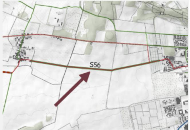
IST-Zustand: Es existiert keine geeignete Wegeverbindung zwischen Gotha und Trügleben. Vorhandene Wege auf dem betrachteten Abschnitt sind teilweise unbefestigt oder verfügen über eine schadhafte wassergebundene Oberfläche. Die parallel verlaufende L 3007 verfügt über keine Radverkehrsanlagen.
